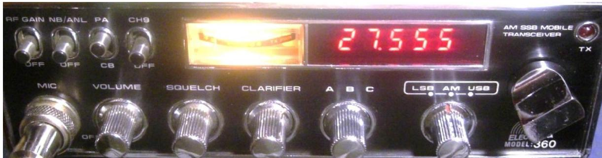
Der Kanalwähler kann gedreht und gedrückt werden. Ein langer Druck auf den Wähler (ca. 1 Sek.) schaltet zw. Kanal- und Frequenzmodus hin und her.
